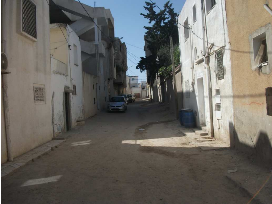
Figure 8: Largeur de l'impasse assez constante, de l'ordre de 5m et visuellement ne contenant pas d'obstacle qui gênera l'exécution d'un réseau de drainage des eaux pluviales.
